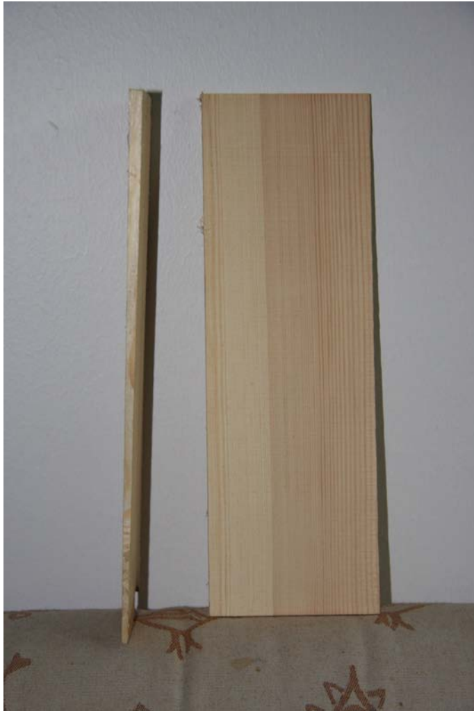
Bilder på nya spån. Spikhålet är ännu inte borrarat. Lägg märke till hur tätvuxna spånen är.
